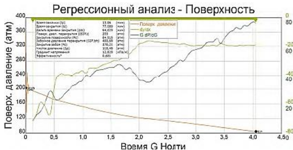
Рис. 2. Параметры точки закрытия 2 стадии Мини-ГРП
